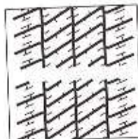
Slijtageprofiel zichtbaar, normale slijtage
